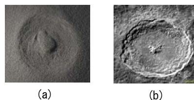
図3 珪砂8号のクレーター(a)と月のクレーター(b)の比較
