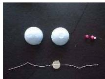
1 発泡スチロール球を電熱カッターで半球にする。磁石にたこ糸をテープでつける。
