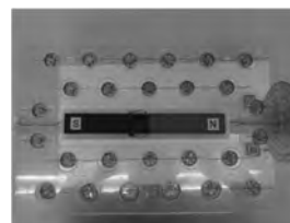
【写真7】棒磁石の極を逆にした実験
