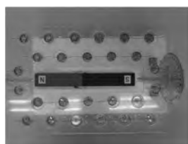
【写真5】棒磁石の磁界(水平の場合)
