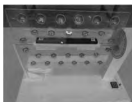
【写真6】棒磁石の磁界(垂直の場合)
