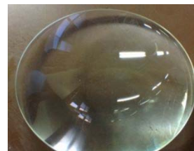
＜写真3＞平凸レンズの 魚眼現象（副実像）。左の 写真と同じように蛍光灯 や柱や窓が映っている。
