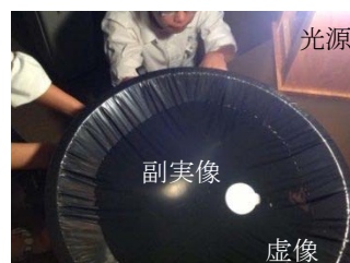
＜写真4＞たらいに平凸型 の水を張った「水レンズ」。 副実像が確認できる。
