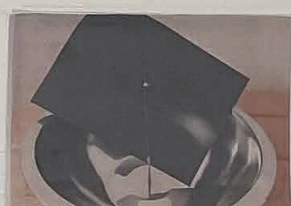
【上部アース】 ゴムベルトにマイナスの電荷をのせるためのアース。高圧電極に接続。
