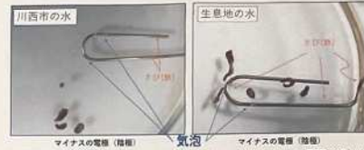
図5 電圧印加中の川西市の水、プラナリア生息地の水におけるマイナスの電極(陰極)付近の様子
