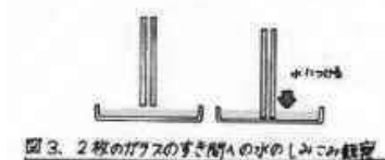
図3. 2枚のガラスのすき間への水のしみこみ観察
