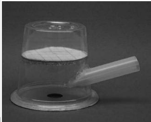
最後に吹出口底面のどの部分で吸着するのかを調べるために実験装置を作り、吸着力を測定しました。その結果、吹出口穴の直ぐ外側に大きな吸着力があり、そこからさらに外側に向かうとだんだん吸着力が小さくなっていくことが分かりました。又、吹出口の穴の中心は、吸着力も吸引力も無い無風地帯であることも分かりました。これらを例えると、台風の仕組みに良く似ていると思いました。
