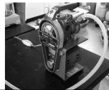
二酸化炭素置換(左)と真空ポンプ(右)
