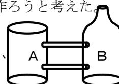
【結果】Bで温められた食塩水は下管を通り、Aに移動するが、下管の位置で溶液移動が止まり、種結晶も溶けてしまった。
