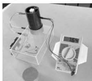
図1. LEDを用いた簡易比色計
