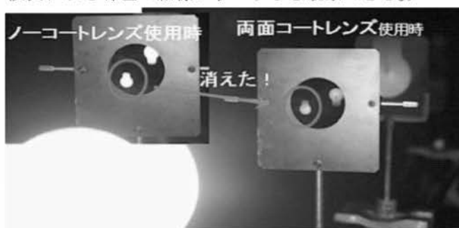
【写真2】両面コートレンズによって副実像が消えるようす
