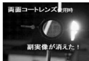
【写真2】両面コートレンズによって副実像が消えるようす
