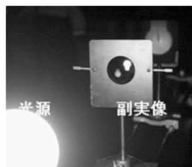
【写真3】片面コートレンズを光源側(左)とスクリーン側(右)に置いたときのようす
