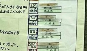
考察 (1)の実験でうまく土砂を止めてくれたので、土石をせき止めると思った。しかし、1つのせきの時は4つのせきの時よりも穴から水の排出が止まらなかった。土石をせき止めても水を止めてくれないのがせきの上からも下からも水が止まってしまった。
