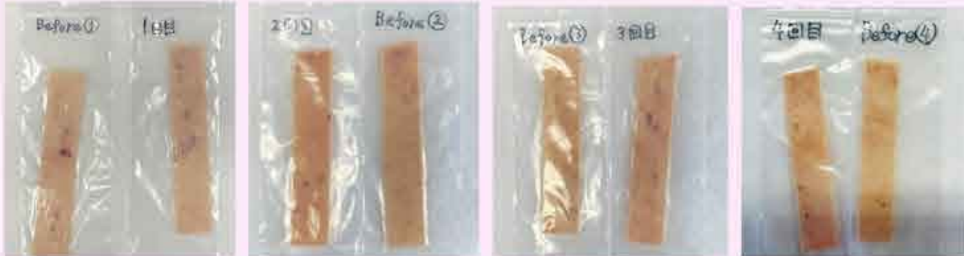
図15 大腸菌キットの結果(左:ろ過前, 右:ろ過後, 左から1回目, 2回目, 3回目, 4回目)
