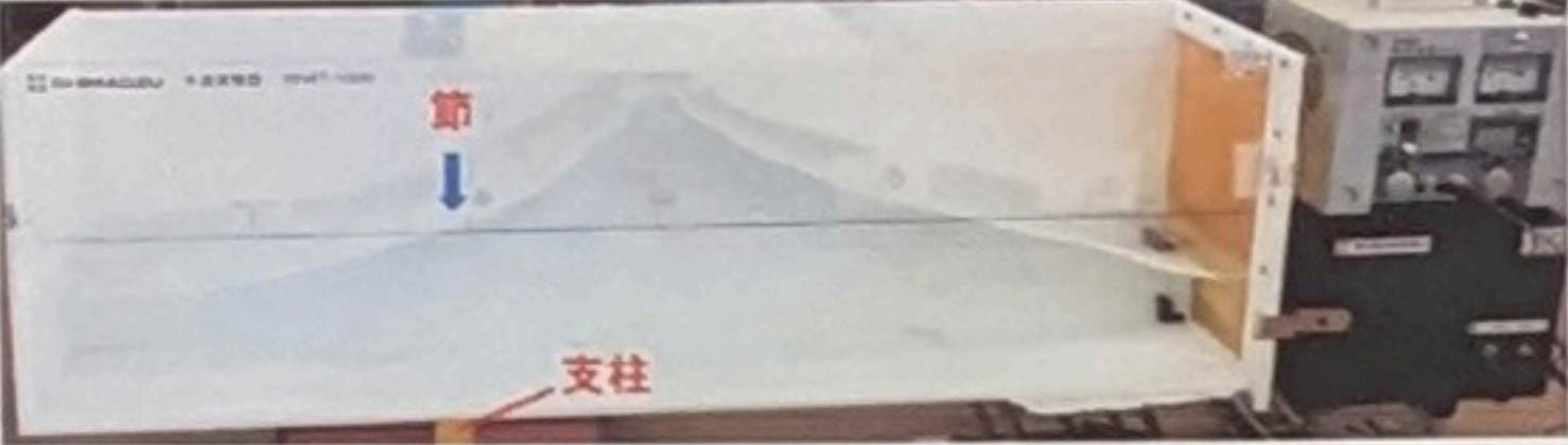
【図4】「節」の位置に支柱を設置し、測定した時の様子
