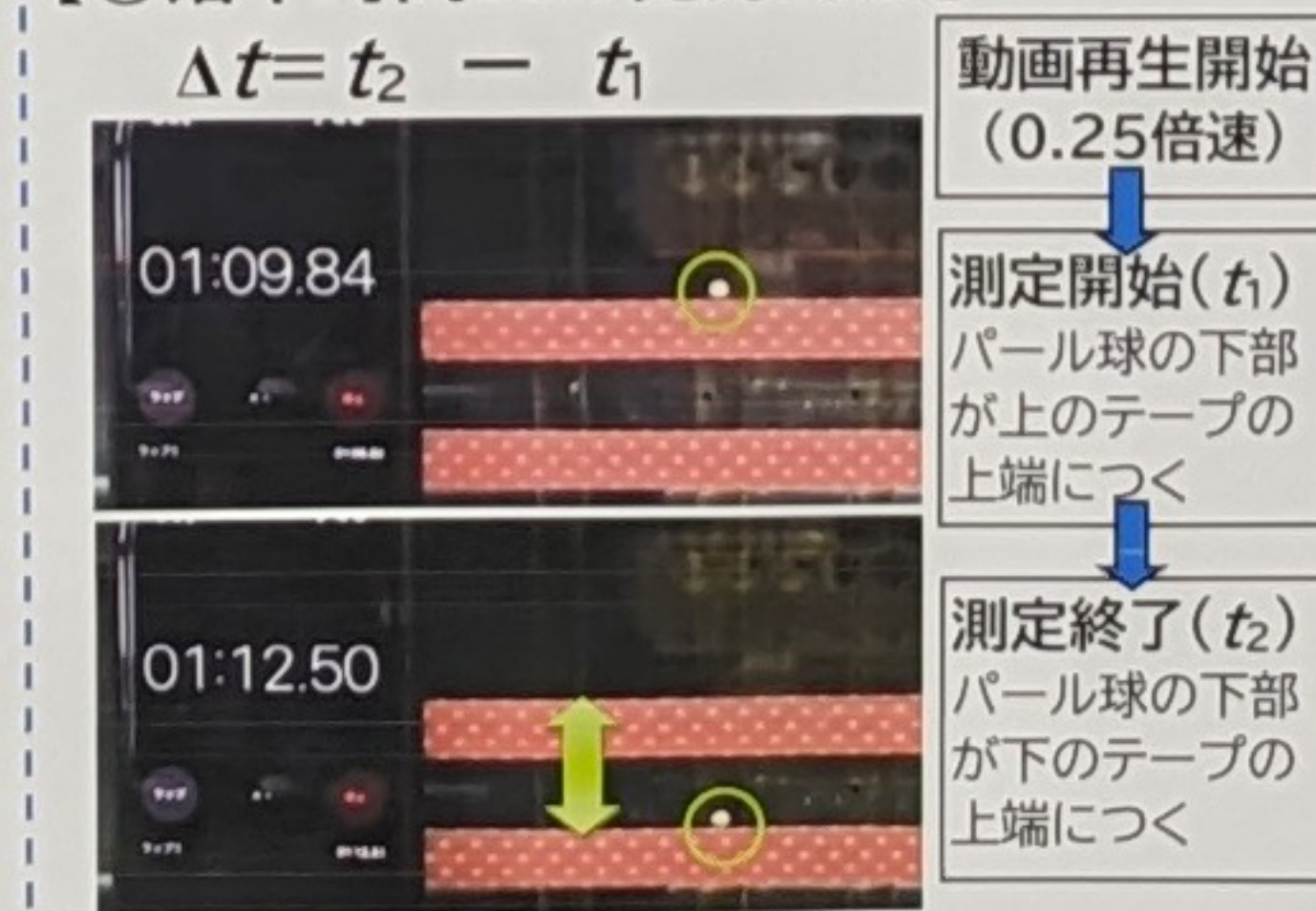
図7 粘度測定の記録方法 記録の基準となる落下時間Δtの記録方法を次のように決定した(図7)。動画を0.25倍速再生して、スマートフォンに撮影された測定開始時刻(t1)と終了時刻(t2)から、落下時間Δtを算出した。
