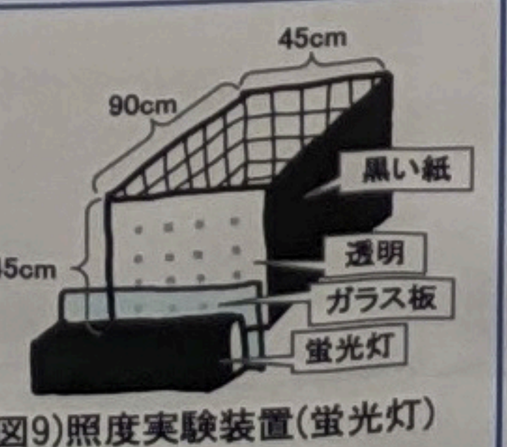
(図9)照度実験装置(蛍光灯)
