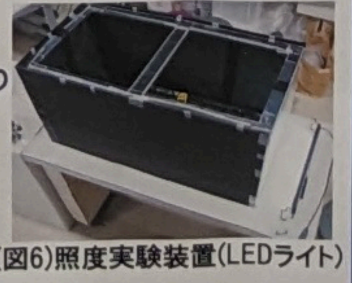
(図6)照度実験装置(LEDライト)
