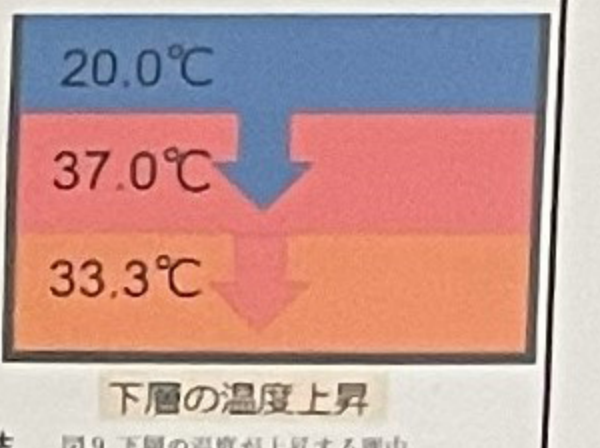
図9 下層の温度が上昇する理由
